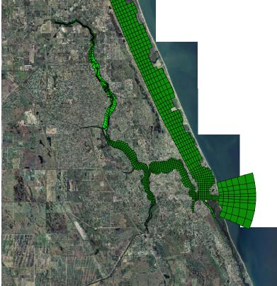
Figure 2. The SLE CH3D model grid
